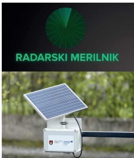
Slika 47 Radarski oziroma ultrazvočni merilnik višine vodostaja
