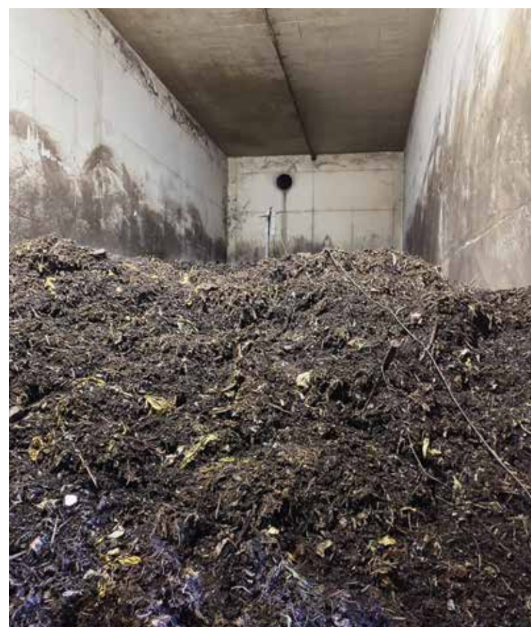
Zaboj s semeni invazivnih rastlin smo zakopali v kompostni kup v RCERO Ljubljana. Poleg zaboja smo namestili sondo, s katero smo odčitavali temperaturo komposta neposredno ob zaboju.
