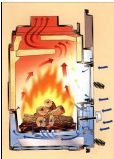
Slika 13; Enostavno kurišče za polena v peči s pregorevanjem (Vir: Kamin Schmid GmbH)
