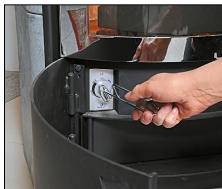
Slika 74; Nastavitev toplotne moči kaminske peči, oziroma dovoda zraka (Vir: www.heimwerkerlexikon.selbermachen.de )
