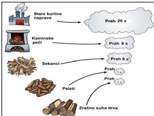
Slika 11; Izpusti prahu ( PM_{10} ) so odvisni predvsem od vrste kurilne naprave, vrste goriva in načina kurjenja (Vir: www.format-x.com )
