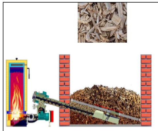
Slika 32; Specialni kotel za sekance (Vir: Fröling GmbH)
