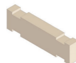
OSNOVNI ELEMENT KONSTRUKCIJE PREREZ: 16 x 8 CM
