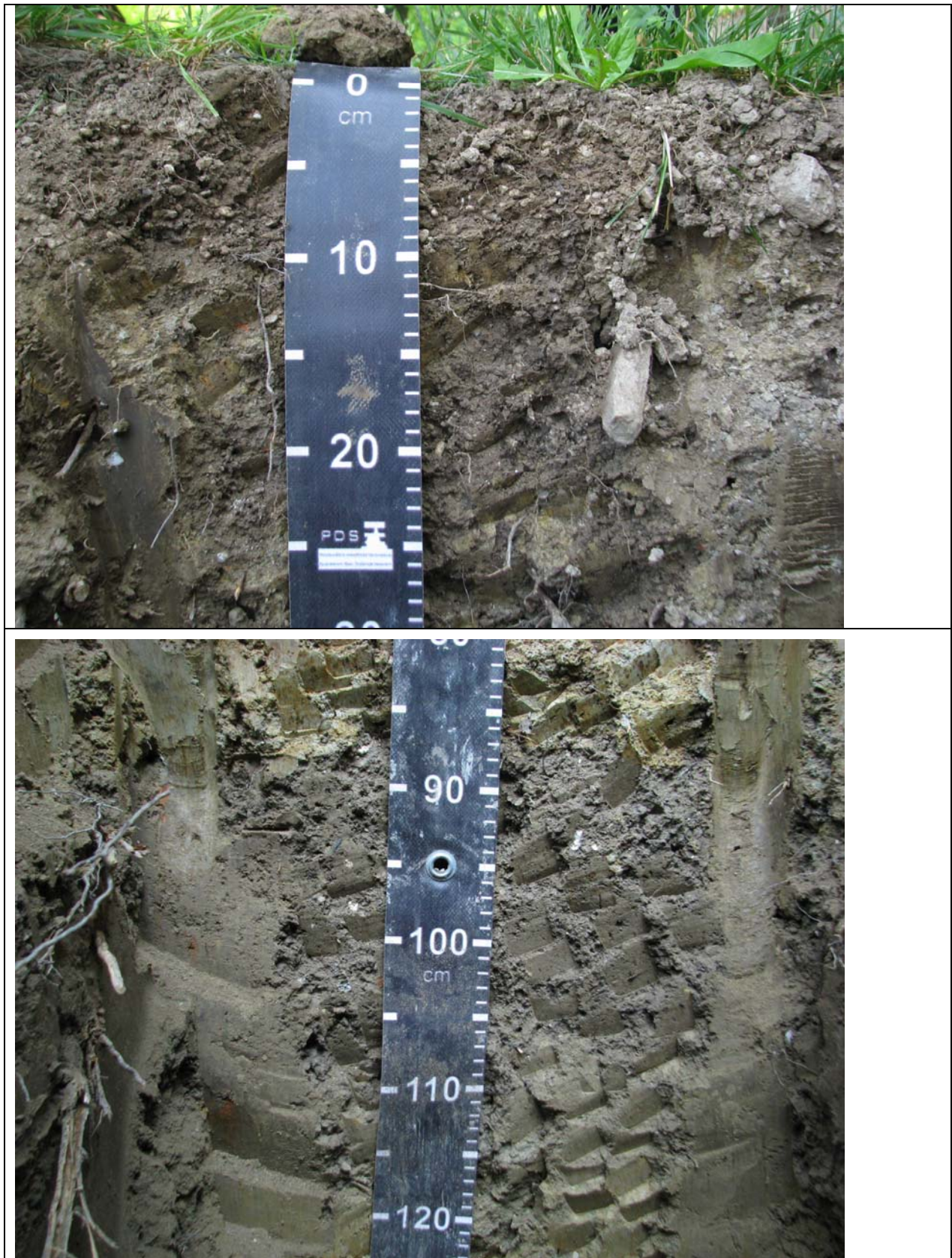
Slika 4: Teksturno lažja tla z veliko karbonatnega gramoza na površini tal profila VVO201- \Phi 3 (zgoraj) in prehod v prvotno površino tal, ki je na tej lokaciji na globni 85 cm – dobro je viden s humusom temnejši prvotni površinski horizont in pod njim mineralni za vodo slabo propustni horizont na globni 115 cm
