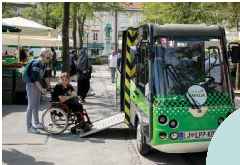
Kavalir s klančino za vstop v vozilo na invalidskem vozičku (foto: Miha Fras)
