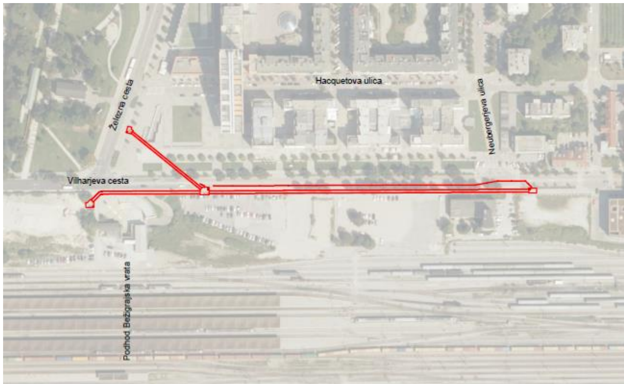
Slika 21 Prikaz prestavitve kanalizacijskega zbiralnika A4 v Vilharjevi cesti po projektu Dograditev javnega vodovoda in kanalizacije zaradi gradnje poslovno trgovskega objekta ob Vilharjevi cesti (Vir: Načrt kanalizacije, št. načrta: 1890-K/21, KONO-B d.o.o.)
