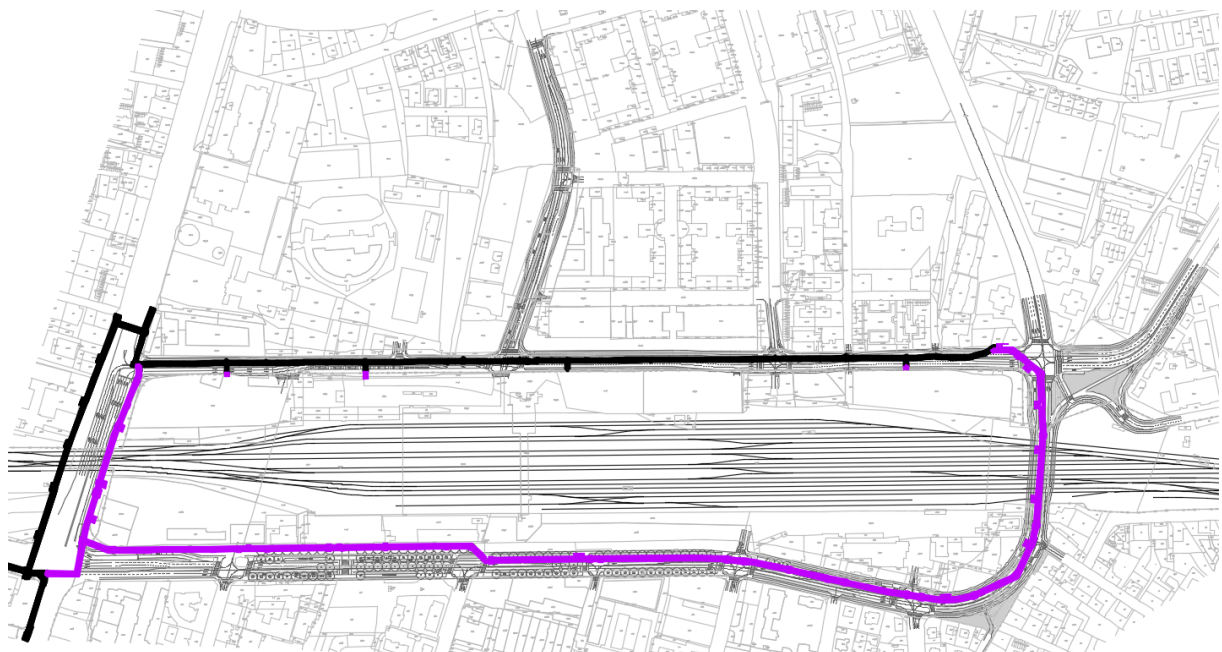
Slika 14 Prikaz poteka kolektorja komunalnih vodov (obstoječi kolektor – črna barva, načrtovani kolektor – vijolična barva)
