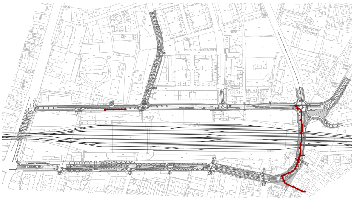
Slika 22 Prikaz načrtovanega vročevodnega omrežja
