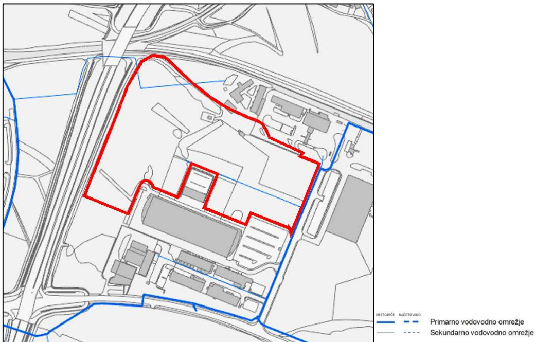
Slika 17: Prikaz vodovodnega omrežja (vir: OPN MOL ID)
