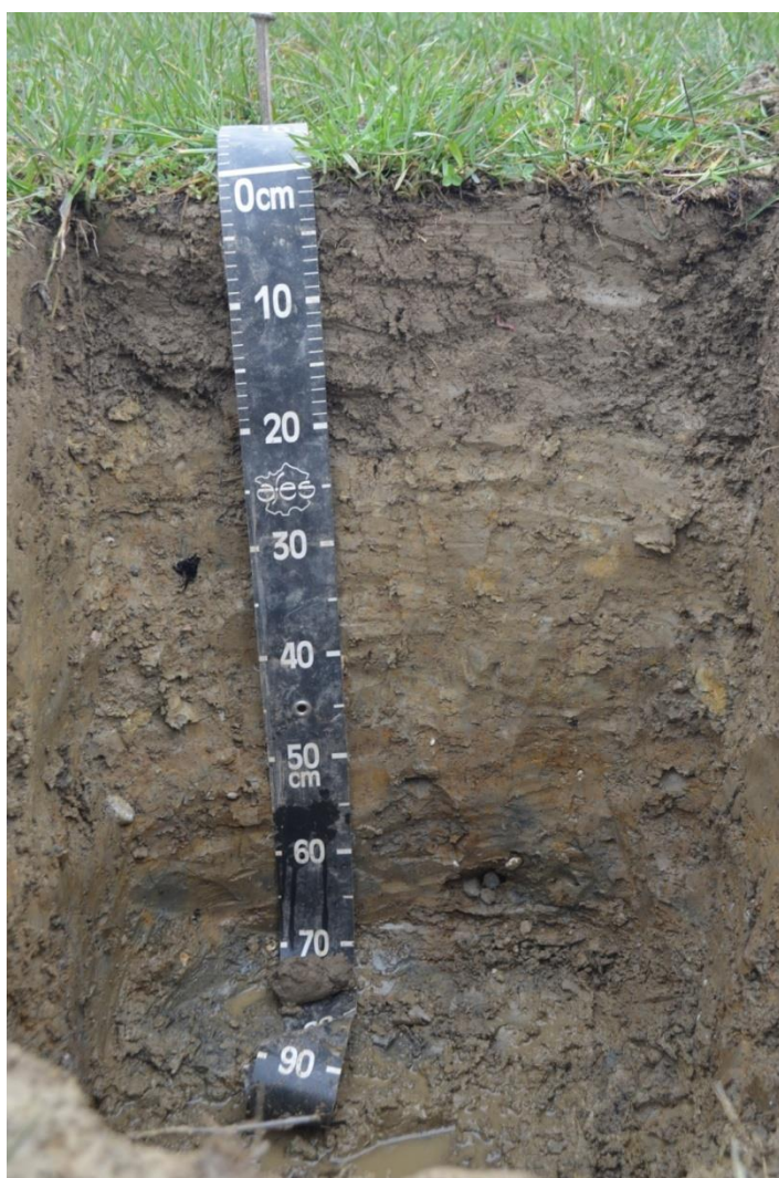
Slika 4: Znaki oglejevanja, ki se pojavijo takoj za obdelovalnim Ap horizontom. Tla uvrščamo med hipogleje (foto: T. Kralj).
