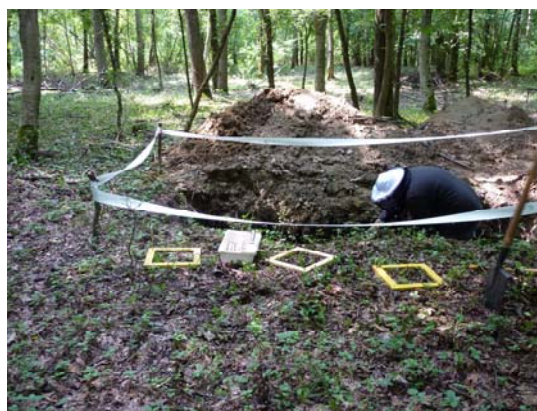
Slika 6.1.3.1: Vzorčenje gozdnih tal, leva stran – vzorčenje organskega dela tal, desna stran: vzorčenje talnega profila (GIS 2006, 2009)
