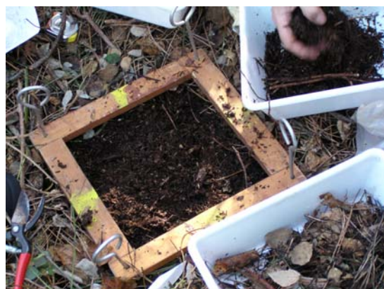
Slika 6.1.3.1: Vzorčenje gozdnih tal, leva stran – vzorčenje organskega dela tal, desna stran: vzorčenje talnega profila (GIS 2006, 2009)
