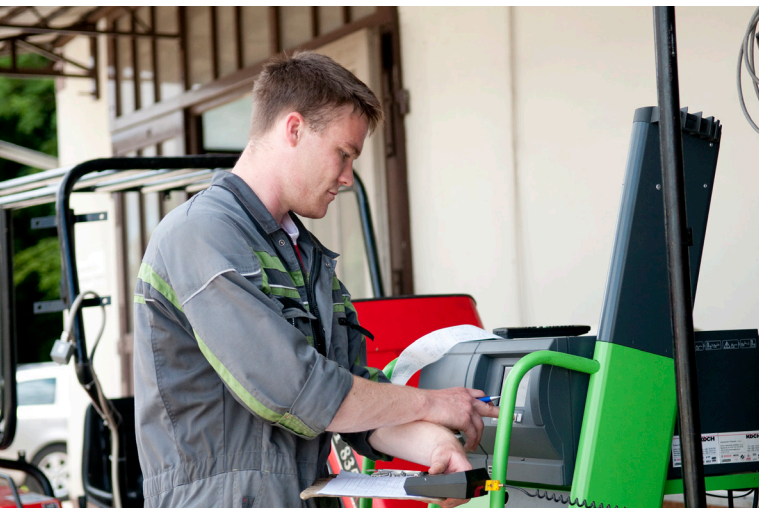
IZVAJALI SMO MERITVE NA VOZILIH S PREDELANIM MOTORJEM NA RASTLINSKO OLJE.
