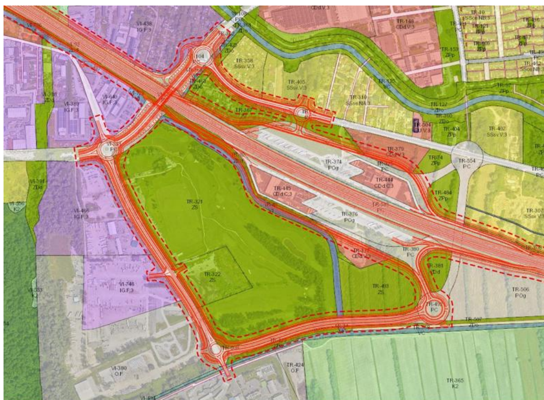
Slika 4.3-1: Idejna zasnova prometnega omrežja in priključevanje na avtocestno obvoznico A1, vir: DARS, 2024, [8]
