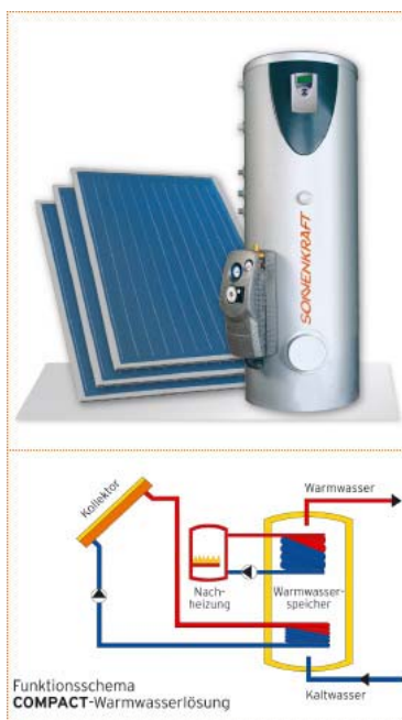
Slika 26: Shema solarnega sistema
