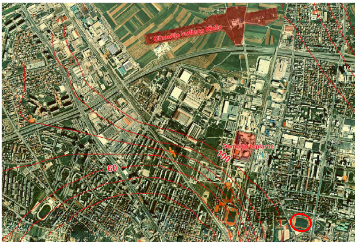
Slika 4: Debelina prodno – konglomeratno – peščenega zasipa, ki sestavlja glavni vodonosnik na Ljubljanskem polju, na predvideni lokaciji (Veselič et. al, 1999)
