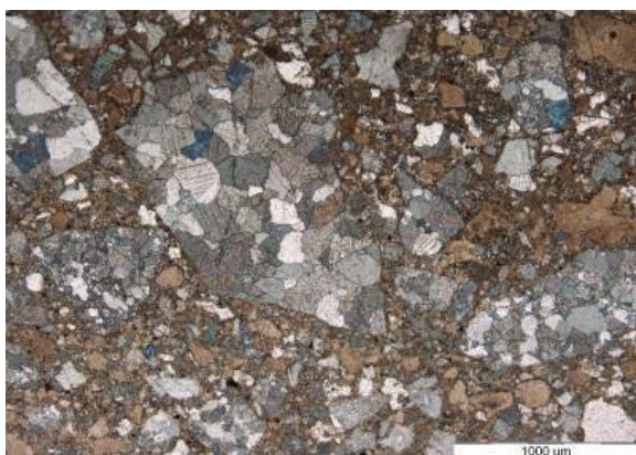
Agregat zunanje plasti ometa sestavljajo ostroroba karbonatna zrna. Opazne so številne karbonatizirane grudice apna. Presečna svetlobna, vzporedni nikoli. Vzorec MNL 14.
