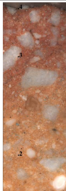
Stratigrafija vzorca MNL 14. (sloj 1 – siv grob omet (ni na sliki); sloj 2 – oker obarvan omet; sloj 3 – svetlo rdeč obarvan omet; sloj 4 – nečistoče) Odsevna svetloba, sestav. fotografija.
