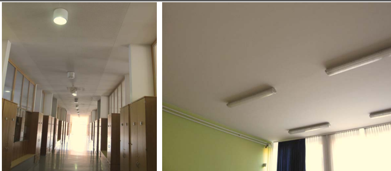
Slika 31: Tipična razsvetljava v hodnikih in razredih
