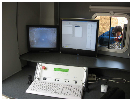
Novo vozilo za pregled kanalizacijskega omrežja s TV kamero
