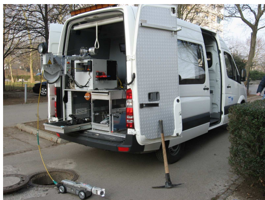
Novo vozilo za pregled kanalizacijskega omrežja s TV kamero
