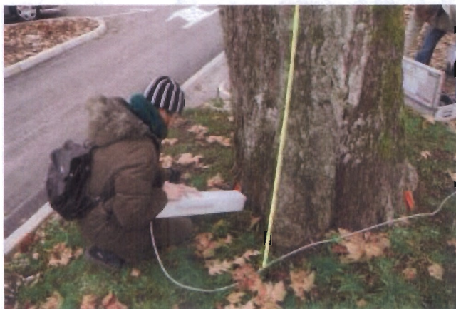
Meritev z rezistografom na korenčniku.
