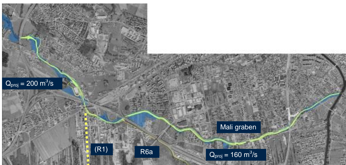
Slika 6: Načrtovani ukrepi v okviru DPN na območju MOL (znotraj AC obroča). Pretočnost Malega grabna se ne odseku med Bokalci in Dolгим mostom poveča na 200 \text{ m}^3/\text{s} , od Dolgega mostu do Ljubljanice pa na 160 \text{ m}^3/\text{s} . Današnja pretočnost je 80 - 100 \text{ m}^3/\text{s} . Računske visoke vode Q_{100} so 243 \text{ m}^3/\text{s} . (Vir: DPN za zagotavljanje poplavne varnosti JZ dela Ljubljane, IZVO d.o.o, 2010.)
