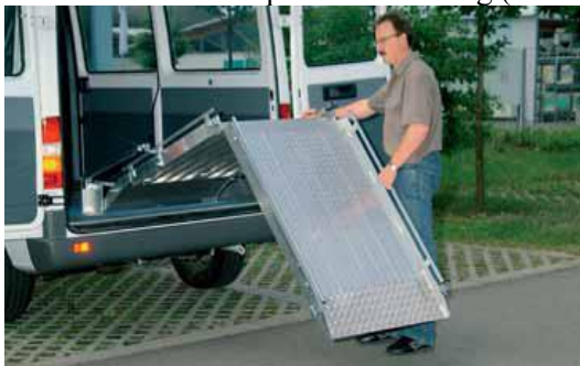
Slika 3: Klančina Tip RLK do 350 kg (vir: arhiv Službe za lokalno samoupravo MU MOL)
