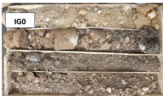
Slika 5: Enota IG0 na jedru vrtine V-OPPN-3 (0-4m).
