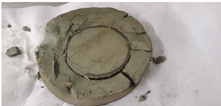
Slika 4: Priprava vzorca iz V-2, globina 9.5-9.8m, za preiskavo stisljivosti
