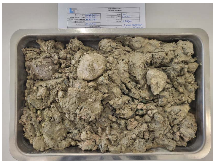
Slika 3: Vzorec iz V-1, globina 6.0 - 7.5m, pred preiskavo zrnivosti
