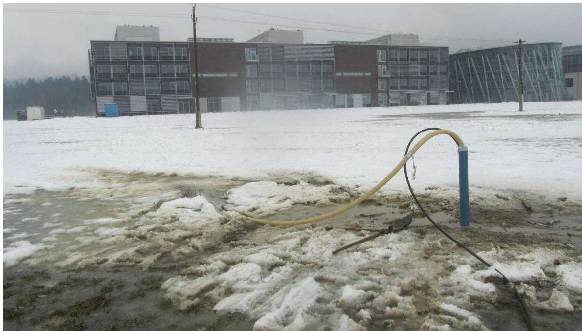
Slika 2 Aktivacija piezometra FS-P1.
