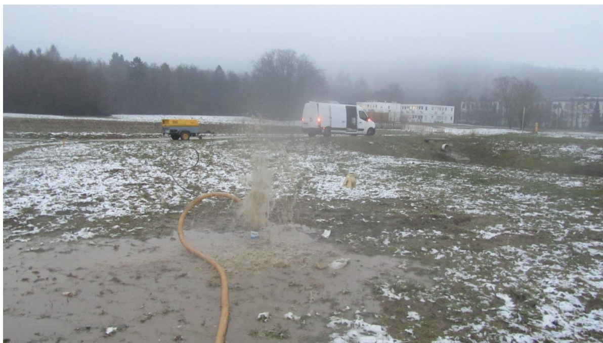
Slika 2 Aktivacija piezometra FFA-P1.
