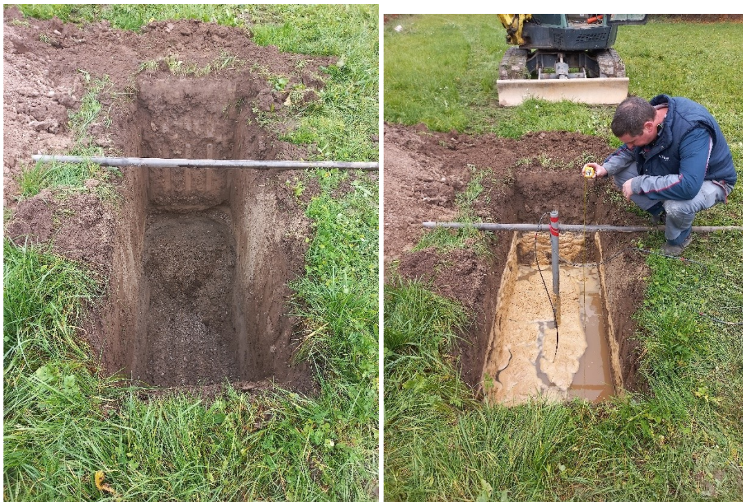
Skica 3 (leva slika): Jašek J-2 izkopan do globine 1,95 m.
