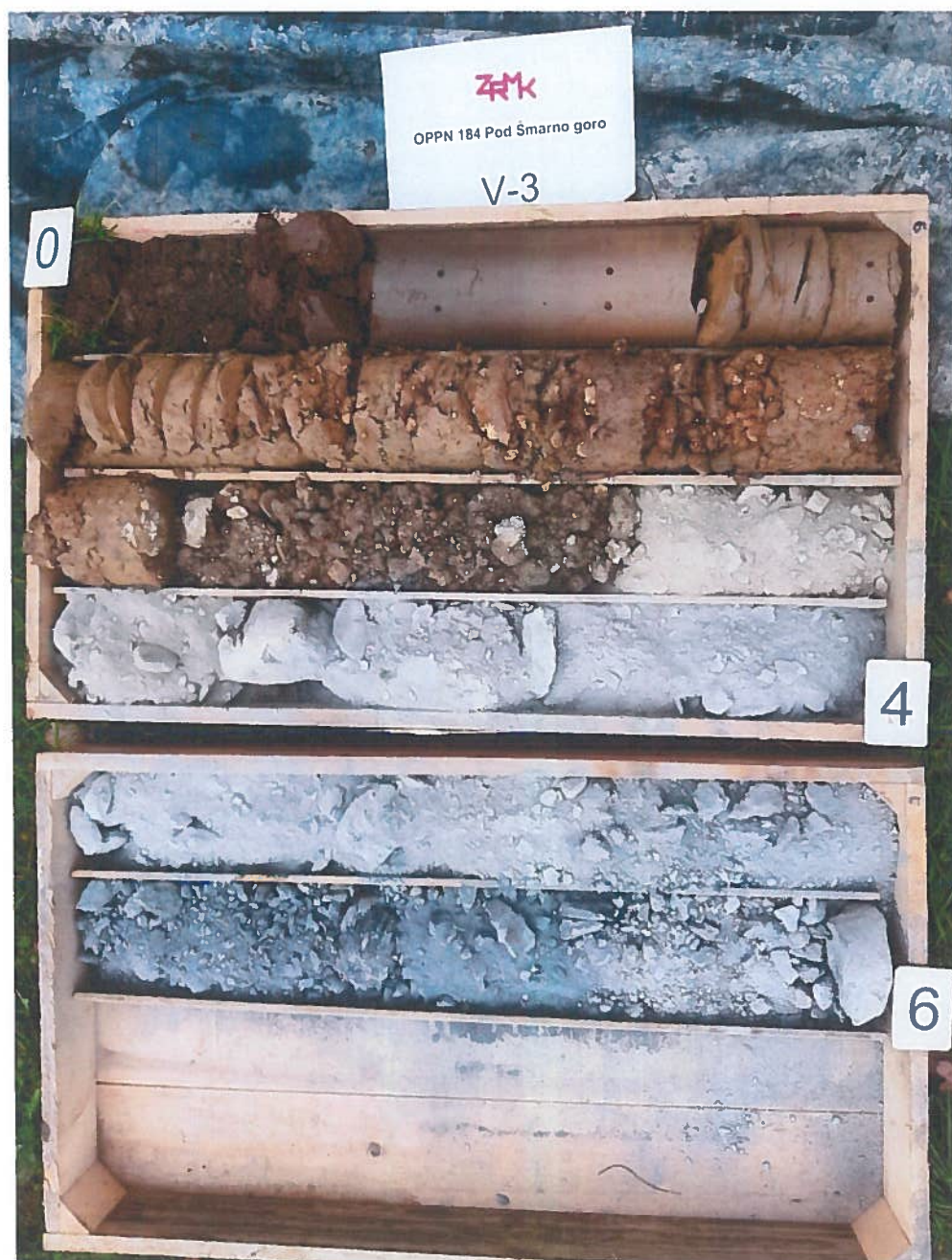
Slika 4: Sondažna vrtna V-3 (0,0 m – 6,0 m)
