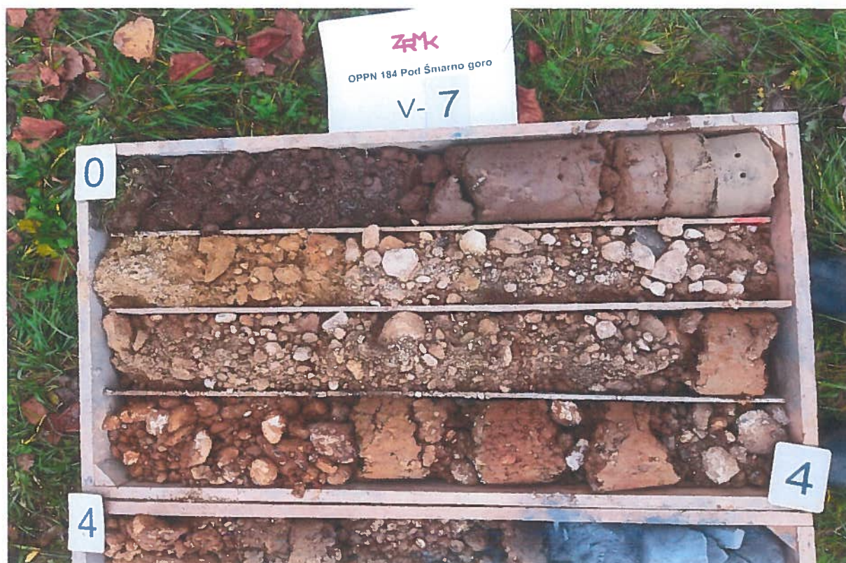
Slika 14: Sondažna vrtina V-7 (0,0 m – 4,0 m)
