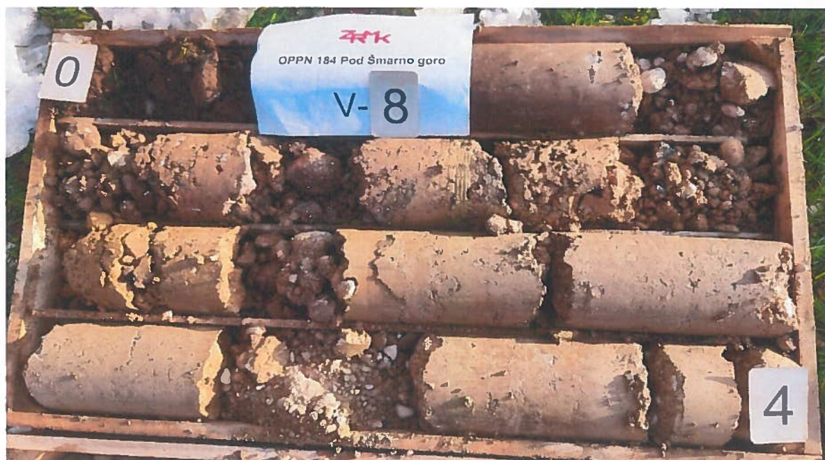
Slika 16: Sondažna vrtna V-8 (0,0 m – 4,0 m)
