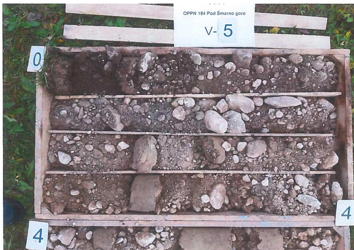
Slika 8: Sondažna vrtina V-5 (0,0 m – 4,0 m)
