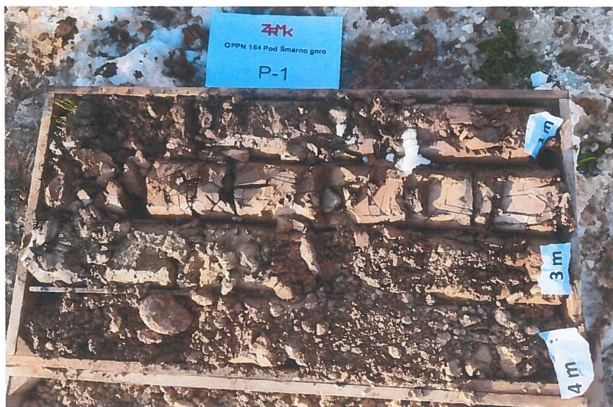
Slika 1: Sondažna vrtina P-1 (0,0 m – 4,0 m)
