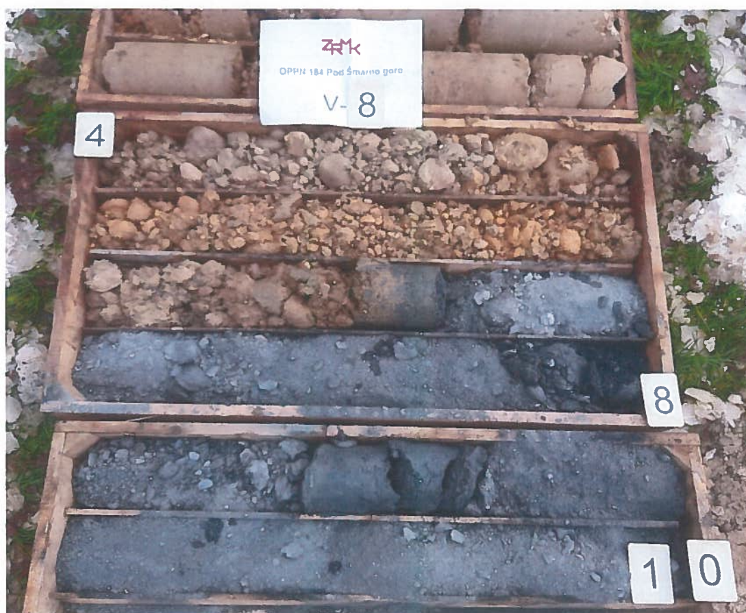
Slika 17: Sondažna vrtna V-8 (4,0 m – 10,0 m)
