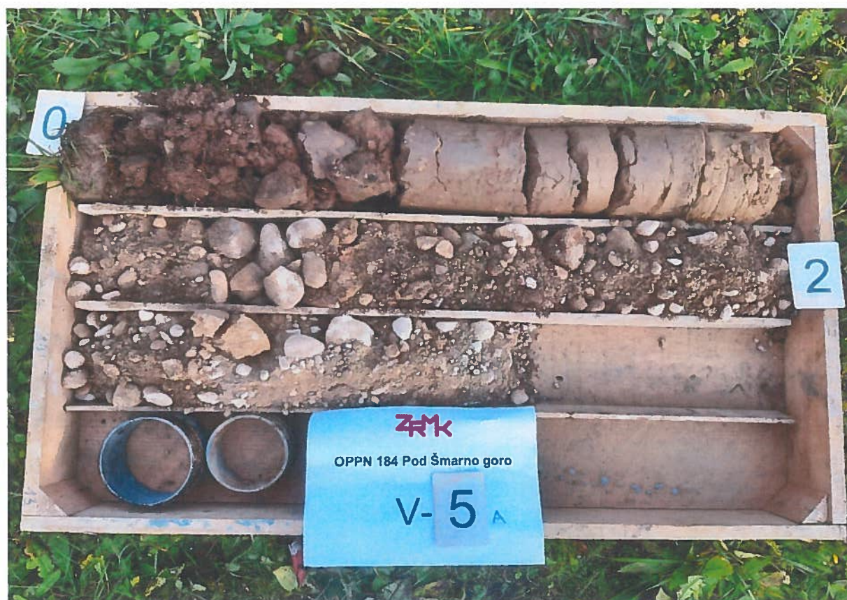
Slika 11: Sondažna vrtna V-5A (0,0 m – 3,0 m)
