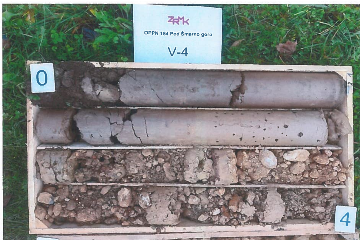
Slika 5: Sondažna vrtina V-4 (0,0 m – 4,0 m)
