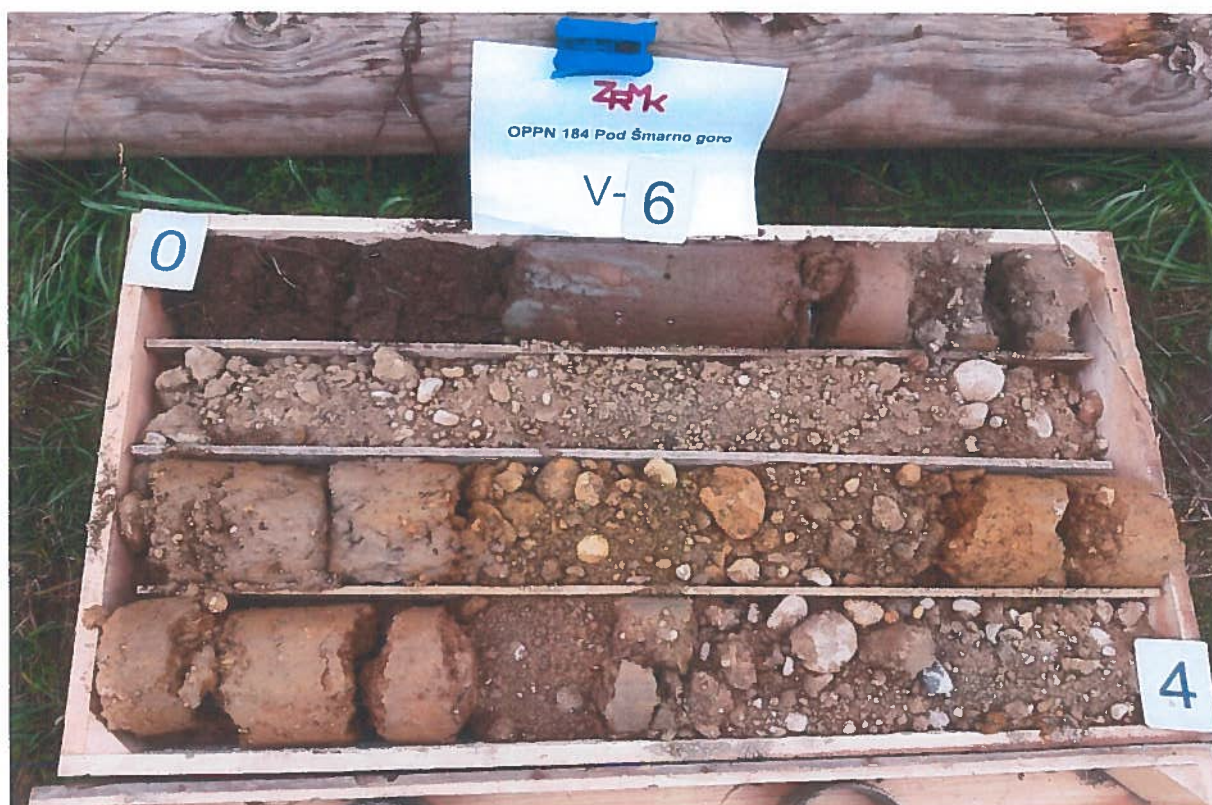
Slika 12: Sondažna vrtna V-6 (0,0 m – 4,0 m)
