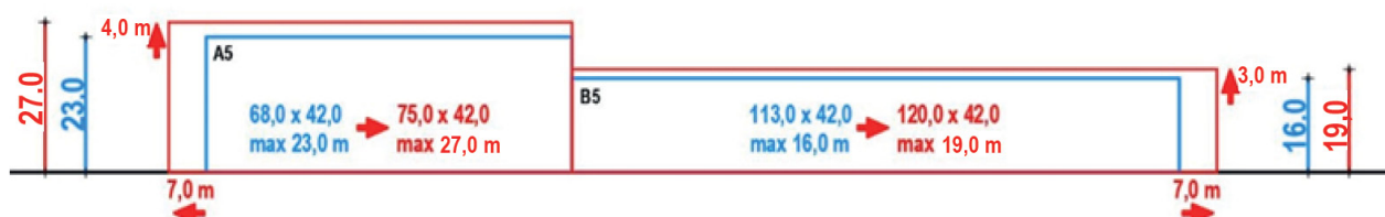
Slika 5: shematski prikaz povečanja višinskih tlorisnih gabaritov objekta avtobusne postaje (vir: Bevk Perović arhitekti).
