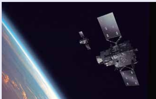
Meteorološki satelit Meteosat tretje generacije v geostacionarni orbiti 36.000 kilometrov nad Zemljo FOTO EUMETSAT
