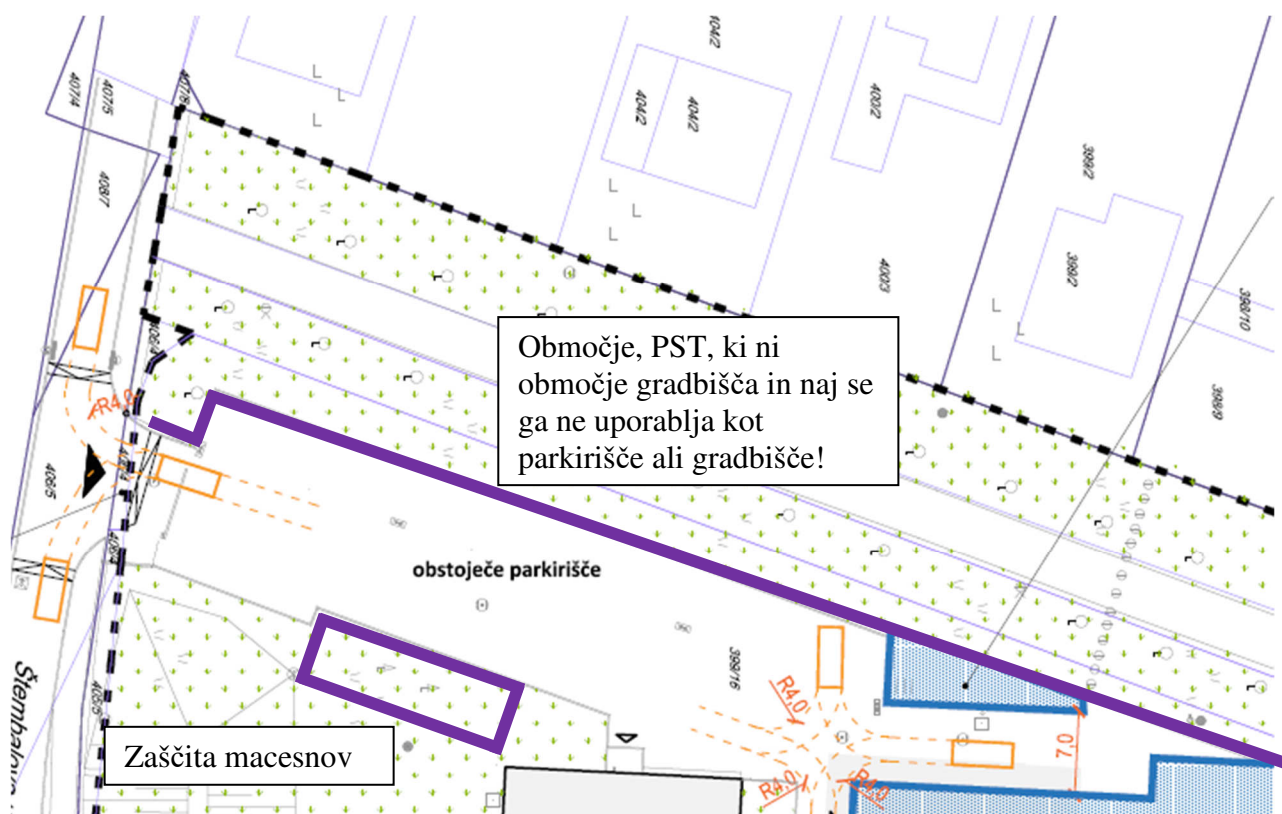
Slika 5: Lokacija zaščitne ograje je prikazana z vijoličnimi črtami. Ograje morajo biti fiksne in prisotne cel čas trajanja gradbišča. Zahodno od ograje je območje POTi in prostor ne sme biti uporabljen kot del gradbišča. (Vir načrta: Curk arhitektura d.o.o.)
