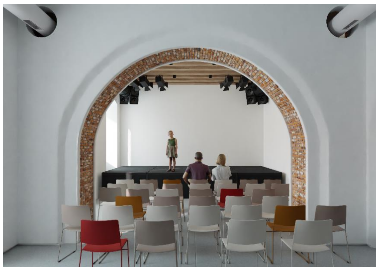
Slika 16: Vizualizacija večnamenske dvorane z vidnimi prezračevalnimi kanali. Ločna stena je obbetonirana s torkretom, ometana z grobim ometom ter barvana z belo barvo. Debelina stene je obdelana s čiščenjem in zaščito obstoječe opeke
