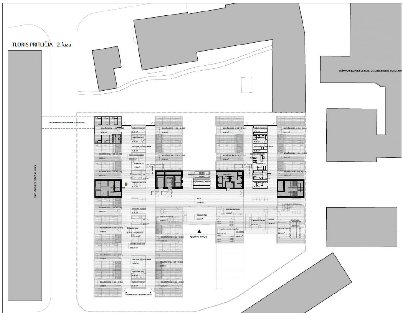
Slika 11: Tloris pritličja po izvedeni 2. fazi nadomestne modularne bolnice (vir: UKC, nadomestna modularna bolnica, idejna zasnova, december 2021, maj 2022)
