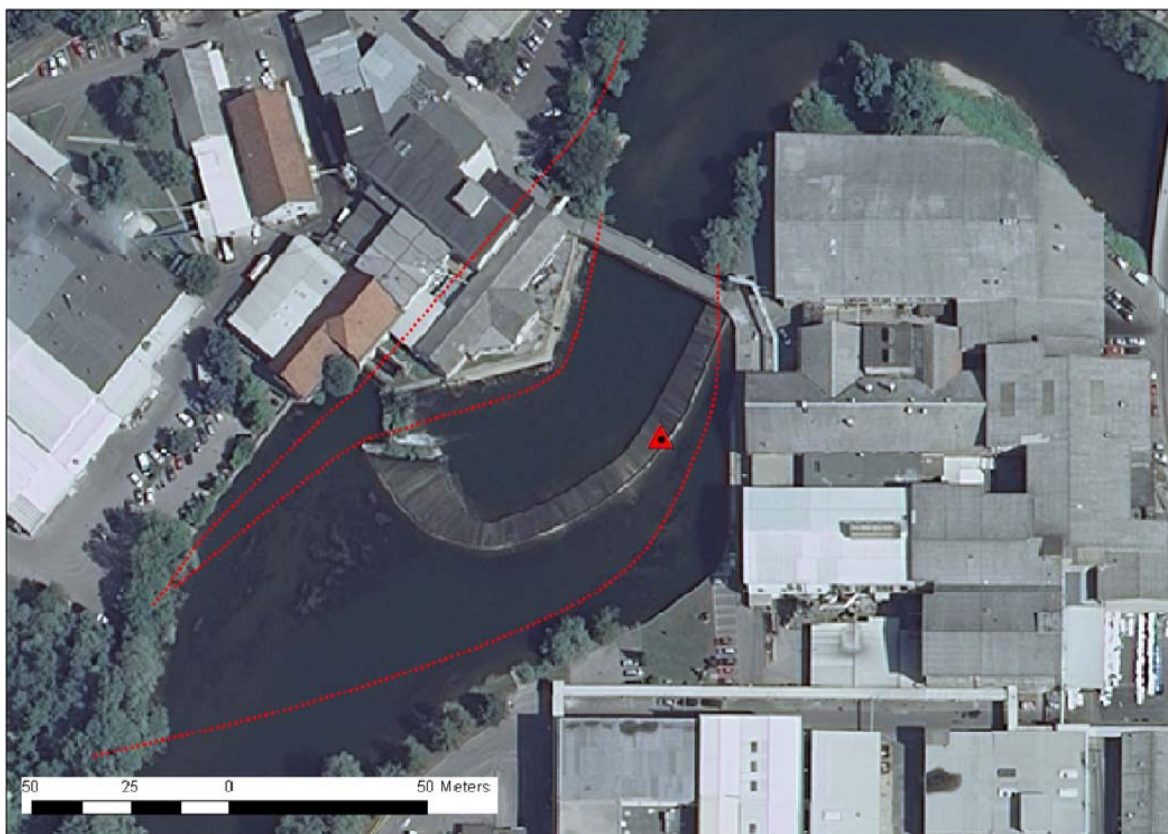
Slika 21: Jez pri papirnici Vevče. Z rdečo prekinjeno črto je nakazanih več možnih poti vodnih živali. Skrajno levo je potencialni prehod, pri katerem je varnost potrebno še preveriti in ga v primeru nevarnosti za živali zavarovati pred vstopom večjih živali v predor.
