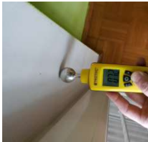
Slika 2: Zamakanje ob špaleti okna
