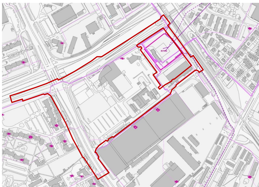
Slika 17: Obstoječe in načrtovano omrežje elektroenergetskih vodov (vir: Urbinfo)
