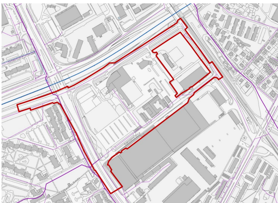
Slika 14: Obstoječe in načrtovano omrežje komunalne in padavinske odpadne vode (vir: Urbinfo)
