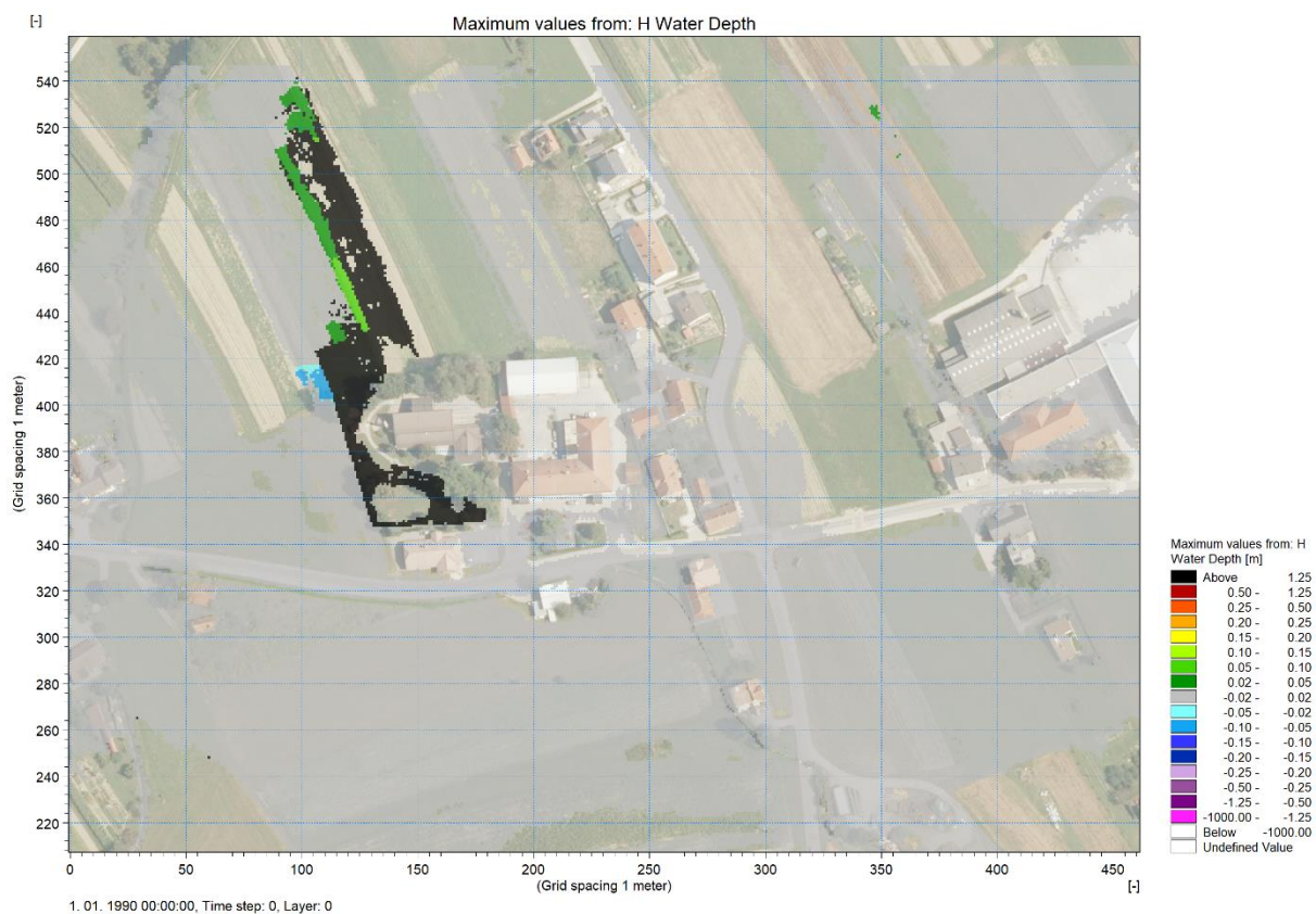
Slika 5: Rezultati razlik gladin med obstoječim in načrtovanim stanjem pri 500-letni povratni dobi.
