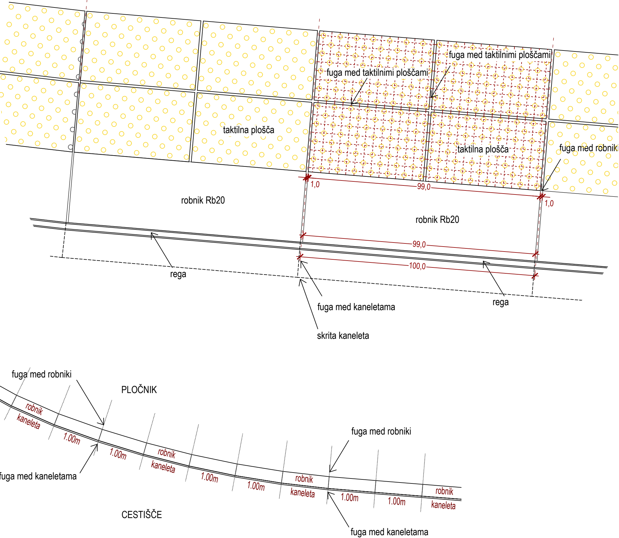
PRINCIP POLAGANJA KANELET M 1:10
