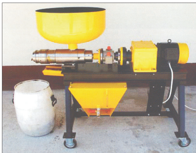
Eksperimentalna stiskalnica za proizvodnjo olja iz semena oljne ogrščice, razvita na Kmetijskem inštitutu Slovenije - Oddelku za kmetijsko tehniko
