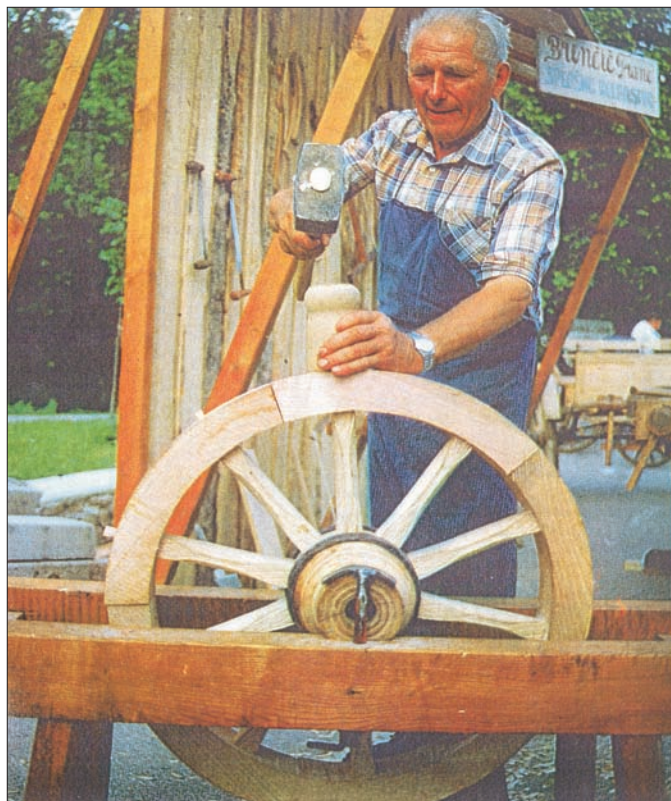
Kolar iz Petkovca pri Logatcu izdeluje kolo za lojtrnik; kolo ima radialno razporejene prečke oz. špice (iz Janez Bogataj: Domače obrti na Slovenskem).
