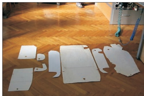
I z d e l a n e šablone avto- tapetniku ola- jšajo izdelavo sedežnih pre- vlek
