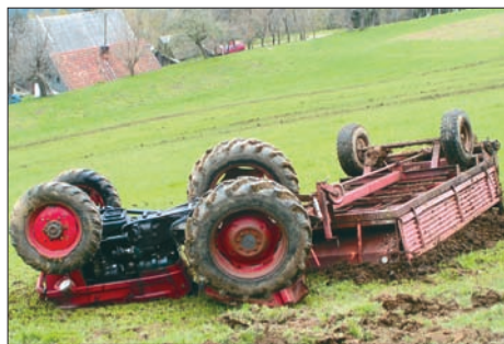
Slika 3: Delovne nesreče s traktorji so bolj pogoste kot cestne nesreče zaradi razgibanega terena, prevelike vlažnosti podlage (tal, trave), dela na prevelikem nagibu itd. Vzrokov nesreč je lahko zelo veliko, najhujše (smrtni) nesreče pa so največkrat posledica prevrnitve traktorja. (vir slike: Dnevnik – Direkt).
