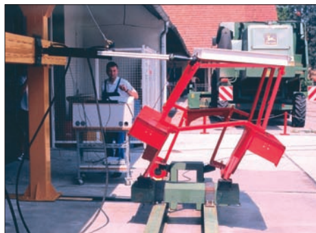
Slika 2: Na Kmetijskem inštitutu Slovenije – Oddelku za kmetijsko tehniko izvajamo tudi trdnostne preizkuse traktorskih kabin. Za to je potrebna posebna merilna oprema in specialna naprava za izvedbo trdnostnih preizkusov. Kabina po končni obremenitvi z bočno silo s pomočjo hidravličnega cilindra (Foto: Viktor Jejčič)
