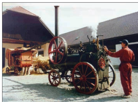
Parna lokomobila iz leta 1903, ki poganja veliko mlatilnico (vir: http://www2.pfmb.uni-mb.si , 18.9.2007)
