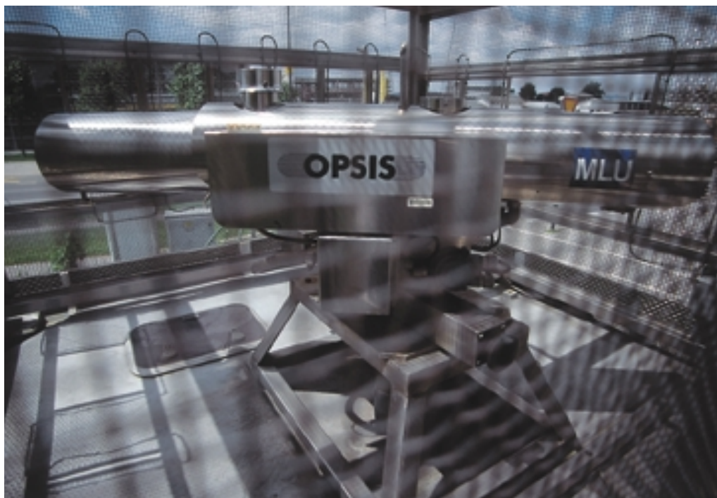
Slika 1-20: Okoljski merilni sistem - merilnik zračnega onesnaženja
