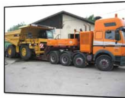
Izredni prevoz - štiriosni priklopnik prevažja demper
