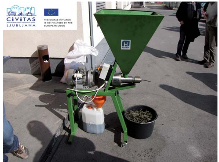
Stiskanje olja z majhno stiskalnico za decentralizirano pridelavo olja in oljne pogače.
