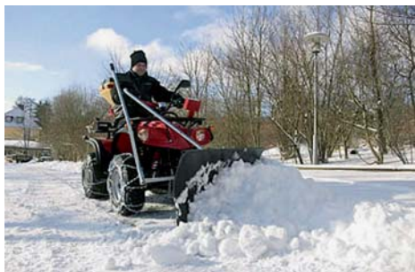
ATV z nameščenim snežnim plugom – pomoč pri čiščenju manjših zasneženih površin (poti, ulic, dvorišč) (vir: http://www.atv-quad.si , 26. 2. 2012)
