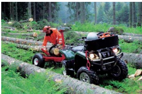
Delovni štirikolesnik, opremljen za pomoč pri gozdarskih opravilih (vir: http://www.atv-quad.si , 26. 2. 2012)
