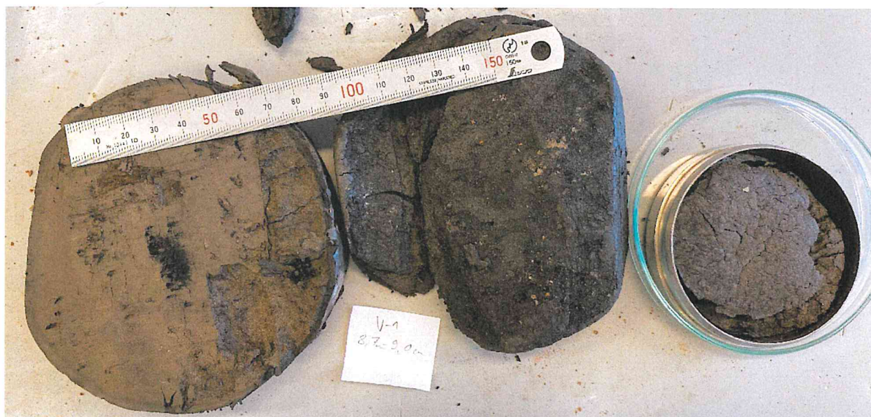
Slika 2: V-1 8,7-9,0 m – od leve proti desni: pusta glina z lečami organske snovi, visokoplastičen melj z razpršeno organsko snovjo in visokoplastičen organski melj (suh preizkušanec).
