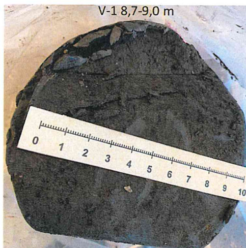
Slika 1: Presek jedra vrtine, vzorec V-1 8,7-9,0 m.
